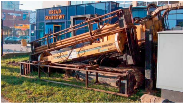
Fot. 4. | Wiertnica Vermeer D80x100 do przewiertów sterowanych o sile uciążu i przepychania 36 t
