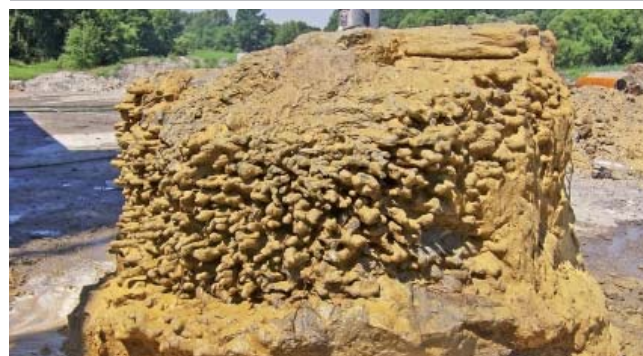
Fot. 5. Próbną kolumna jet-grouting \phi 800 mm Belk
