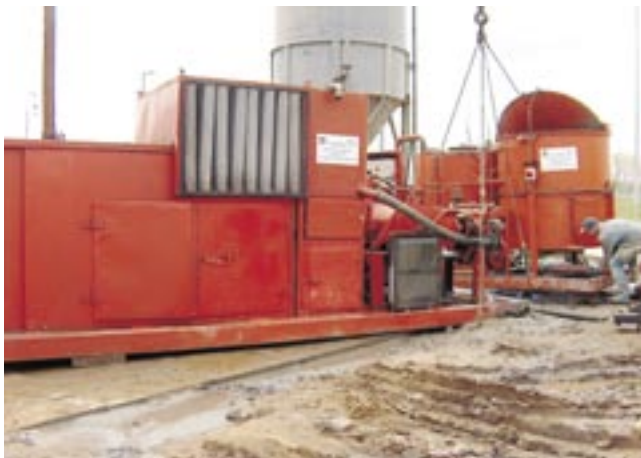
Fot. 3. Tłokowo- rurowa pompa wysokociśnieniowa Halliburton HT400
