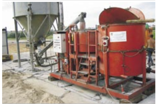
Fot. 7. Mieszalnik automatyczny do zaczynu cementowego, sterowany komputerowo
